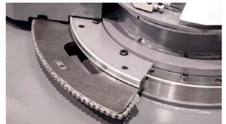
Permettant des coupes droites et biaisées à 45° (*gauche et droite*) et à 60° à droite.
