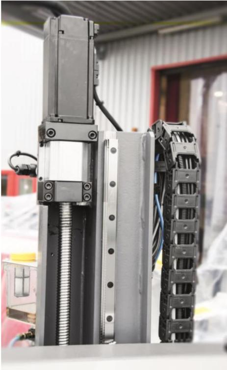
Descente de l'archet de sciage sur 2 colonnes à glissières linéaire et par vis à billes et servo-moteur
