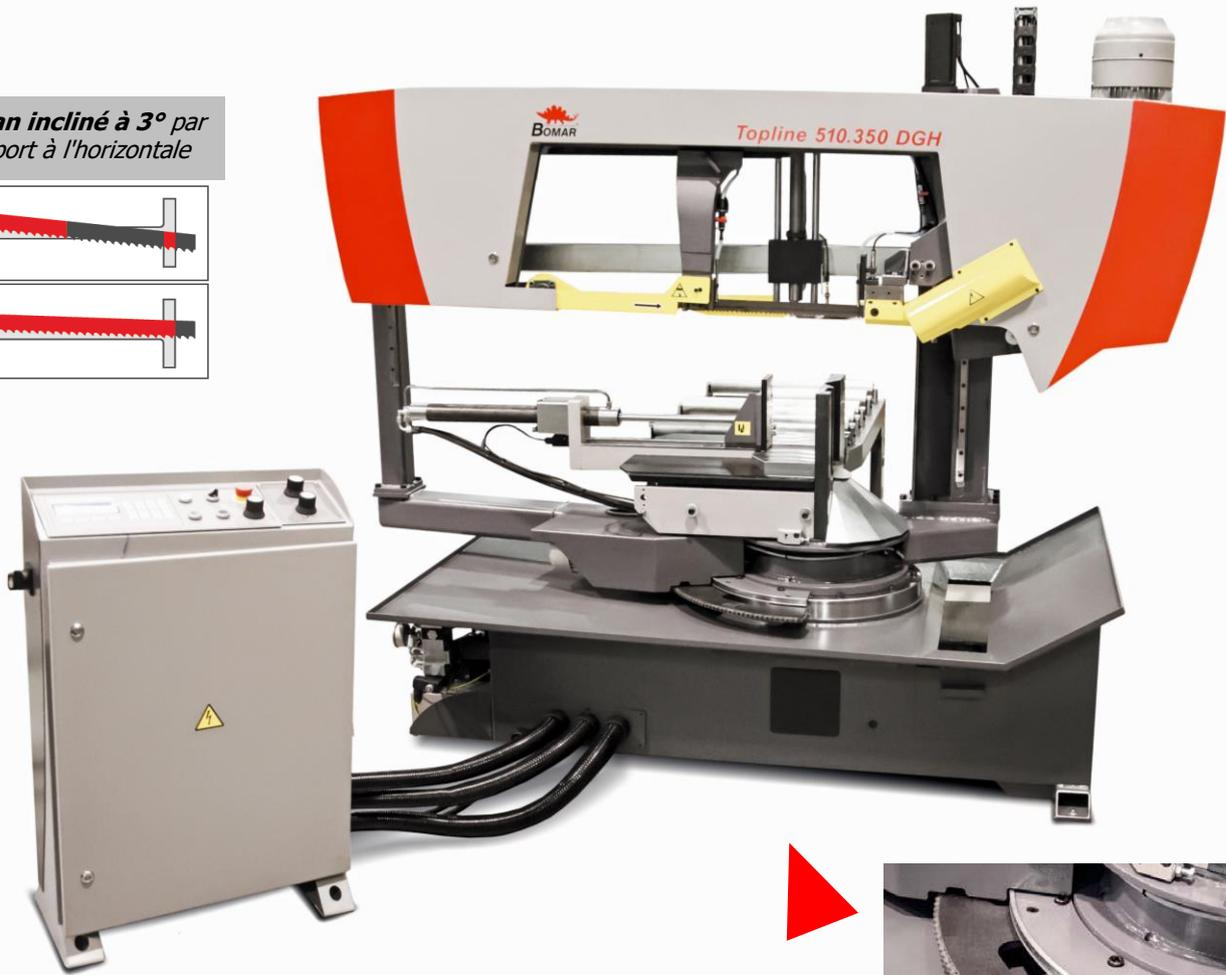
*Pivotement automatique motorisé de l'archet de sciage en OPTION*
